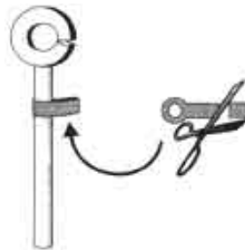
Figure 3 : la longueur de la plate-forme en Polycel est ajustée.
